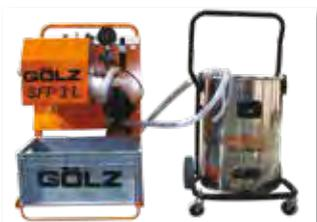
Schlammflux pompant le contenu de l'aspirateur
