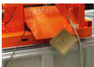
Expulsion des galettes de boue en fin de cycle de filtration
