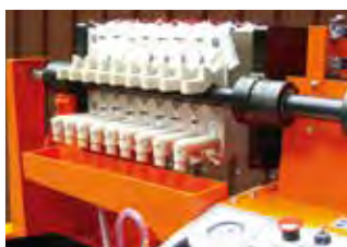
Chambre à filtres
