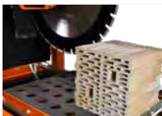
Profondeur de coupe jusqu'à 235 mm
