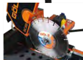
Disque de coupe facile à remplacer
