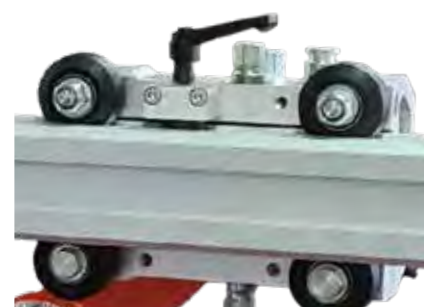
Guidage par roulements
