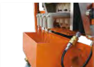
Évacuation de l'eau filtrée
