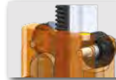
Guidage par roulements latéraux
