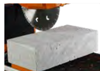
Coupe jusqu'à 280 mm (par retournement de la pièce)
