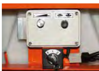
Démarrateur électrique et pupitre de réglage
